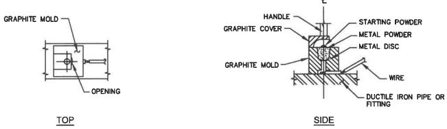
HOLD GRAPHITE MOLD FIRMLY OVER ADAPTER SLEEVE WITH OPENING AWAY FROM OPERATOR — IGNITE STARTING POWDER.
